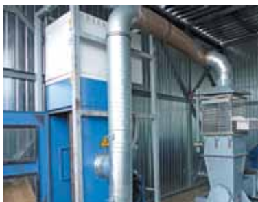
Расслаивающая отсадочная машина allair® для циклических тестов
