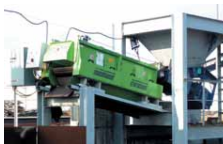
В составе тестовой установки грохочения — вибропитатель Jeffrey Rader и звездчатый грохот Starscreen
