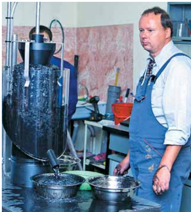
Лабораторный вариант установки для флотации (обезвоживания) шламов и техногенных отходов, установленной на кафедре обогащения полезных ископаемых, тестирует представитель немецкой фирмы MBE Coal & Minerals Technology GmbH, октябрь 2011 года
